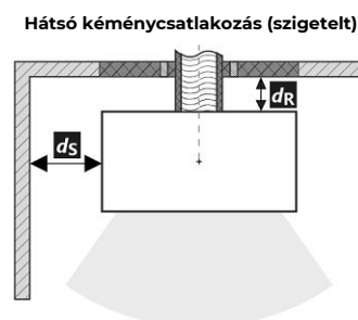
A füstcső áthaladása éghető anyagból készült falon
