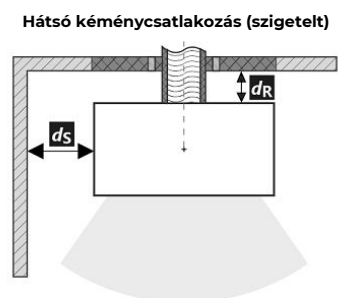
A füstcső áthaladása éghető anyagból készült falon
